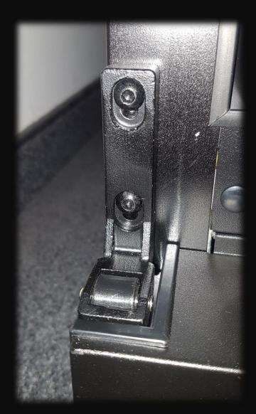
Jetzt die beiden Schrauben der Führungsrolle mit einem Inbusschlüssel Grösse 3 lösen und ganz nach unten stellen.
